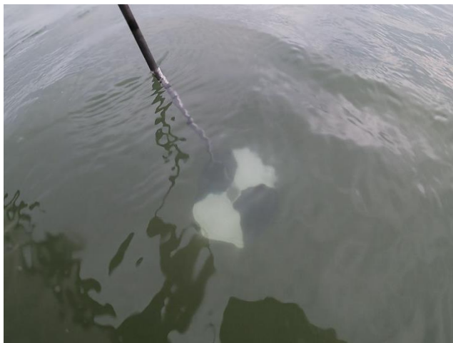
Station Gr Travers : mesure de la visibilité (110 cm)
