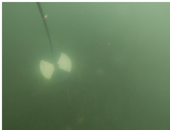
Station Carnon : mesure de la visibilité (105cm). Fond observé, herbier de Zostera Noltii
