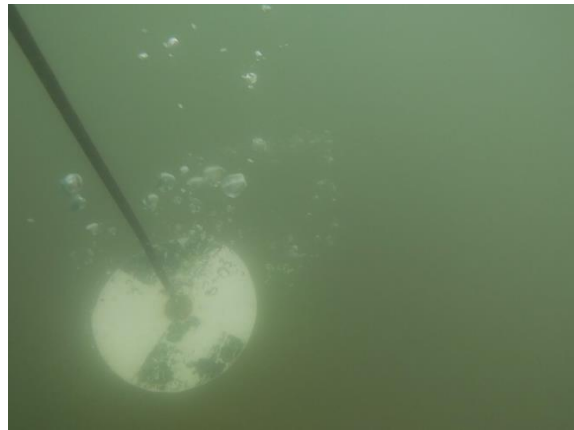
Station Carnon : prise de mesure de la turbidité avec le disque de Secchi
