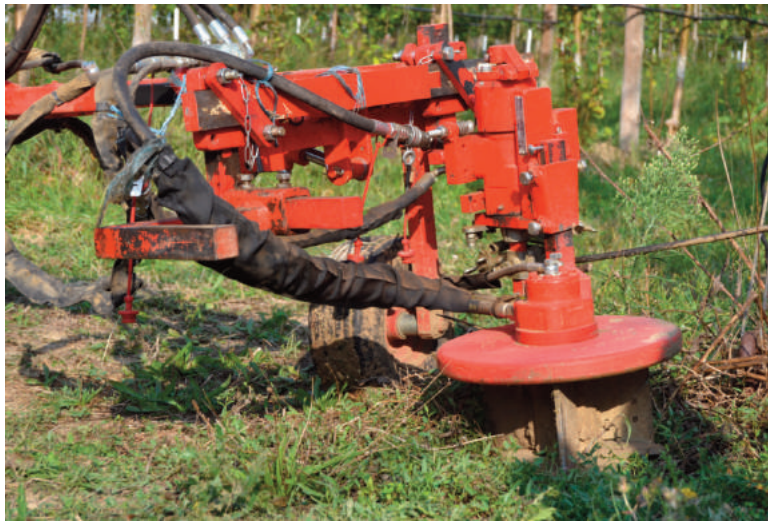
Le Pétalmatic de Boisselet avait été positionné à l'avant du tracteur dans cette démonstration. Un positionnement qui facilite le travail et le confort du conducteur.
