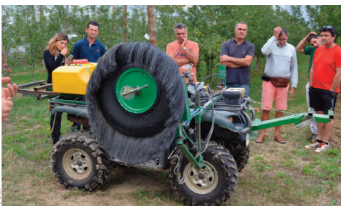
La rampe Undavina permet de localiser les traitements avec des bouillies de 25 l/ha dont 2 à 3 l de Roundup seulement.
